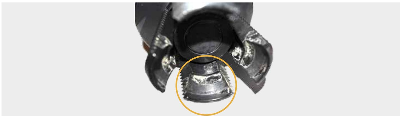
Die Gleitflächen von Spreizkeilen und Spreizkegel müssen eine einheitliche Oberfläche ohne fühlbare Riefen aufweisen. Verschmutzungen müssen wie bei Bild 1 entfernt werden.
