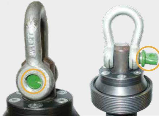
Der Bolzen des Schäkels muss bis zum Anschlag eingedreht sein.
