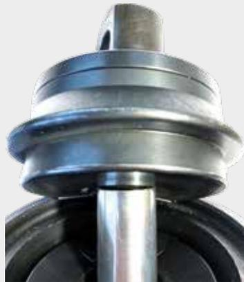
Die Kugelstange muss mit der Halbkugel oben starr verbunden sein, ein Verdrehen zwischen Halbkugel und Kugelstange darf keinesfalls möglich sein.
