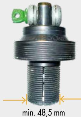
Der Durchmesser des Spreizelementes darf in zusammengedrücktem Zustand nicht weniger als 48,5 mm aufweisen.
