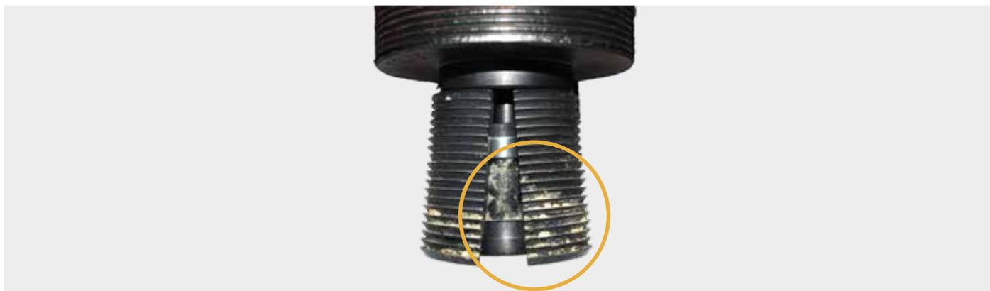
Verschmutzungen müssen mit Druckluft, Drahtbürste oder Harzlöser vor jedem Hebevorgang entfernt werden.
