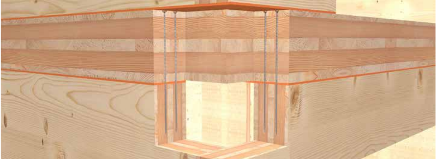
Verbindung von Deckenelementen durch internes Stoßbrett
