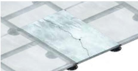
Erhöhte Bruchgefahr einzelner Platten aufgrund fehlender Stützprofile.
