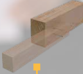
CONEXIÓN PARALELA
