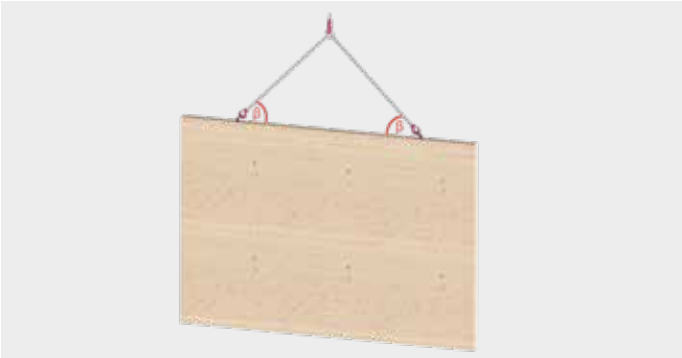
CLT-Wand oder-Träger stehend
