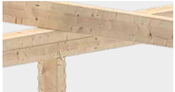
Befestigung von Stützen bei Holz-Rahmenkonstruktionen
