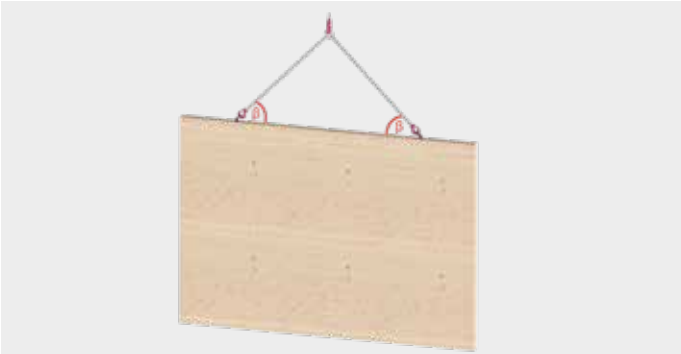
CLT-Wand oder-Träger stehend
