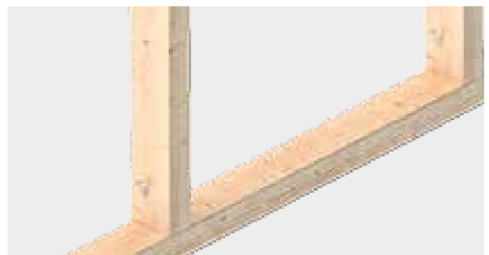
Befestigung von Stützen bei Holz-Rahmenkonstruktionen im Fußschwellenbereich
