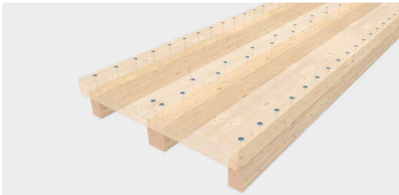
Pressdruckverteilung bei der Schraubenpressklebung von Holzrippenelementen
