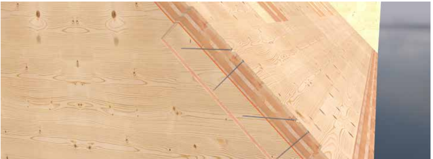
Verbindung von Dach- und Wandelement
