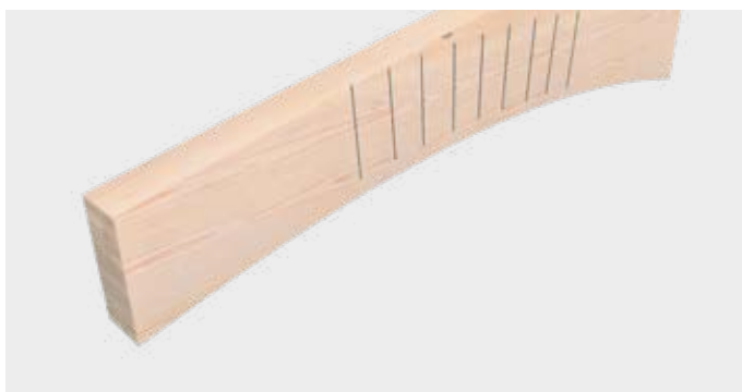
Verstärkung von trapezförmig gebogenen Balken
