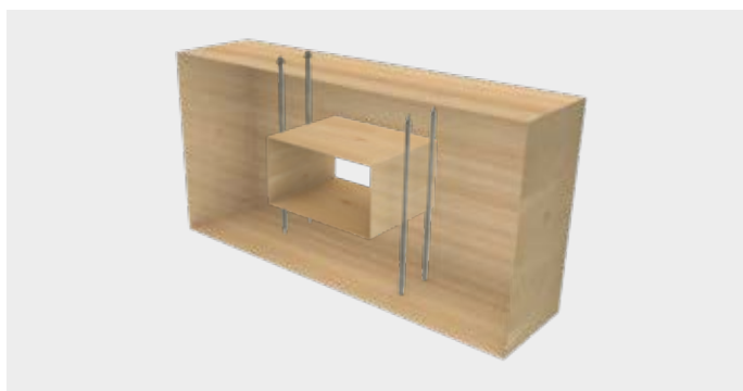
Verstärkung von Balkenöffnungen
