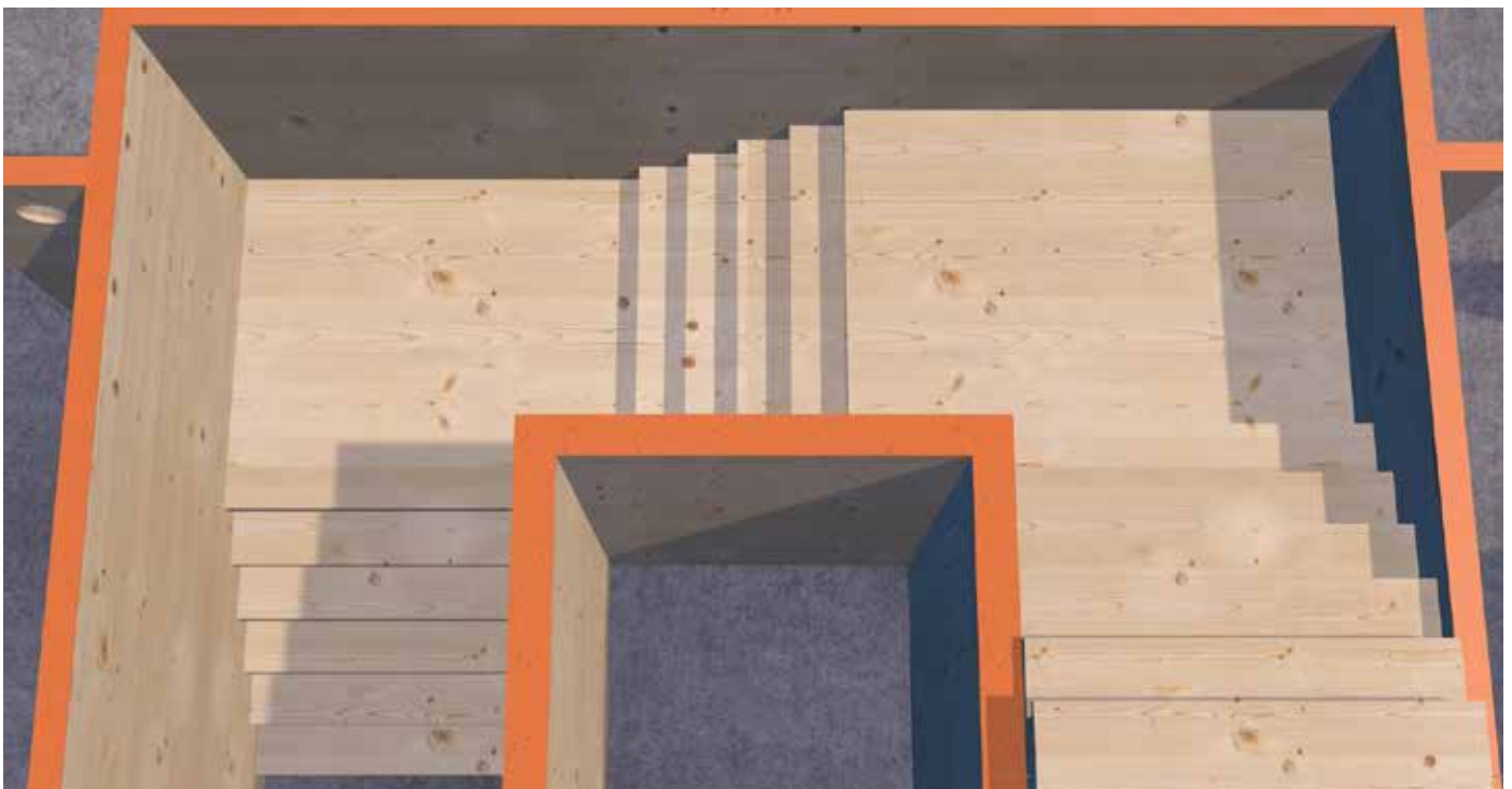
3 Stufen oben auf der Stufenauflege anbringen.
