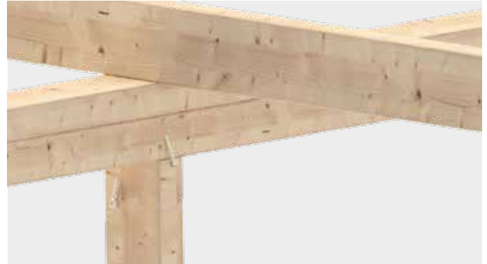
Befestigung von Stützen bei Holzrahmenkonstruktionen
