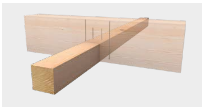
Verstärkung der Haupt-Nebenträgerstützen
