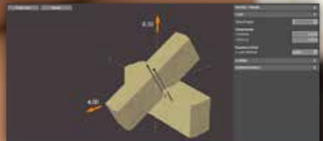
Moduł do połączeń krokwi z płatwami przy użyciu śrub Paneltwistec i KonstruX.
