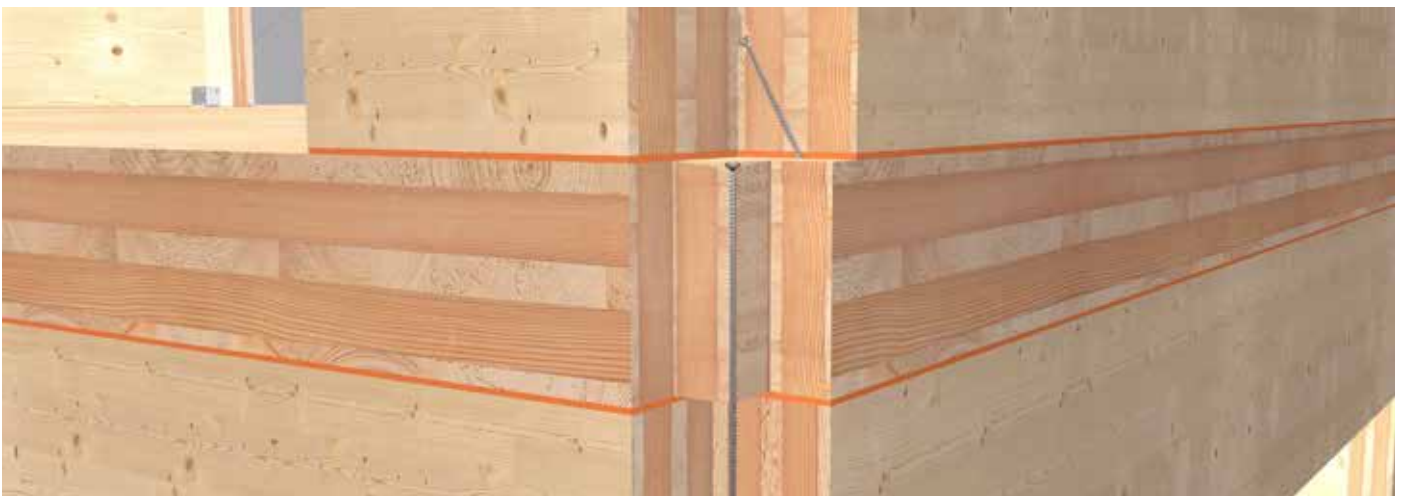
Verbindung von Wand und Holzboden im Obergeschoss
