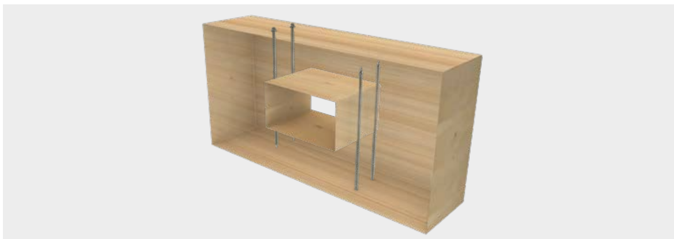
Verstärkung von Balkenöffnungen
