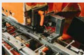
**4** Soudage (fusion d'une section de fil en acier au carbone)
