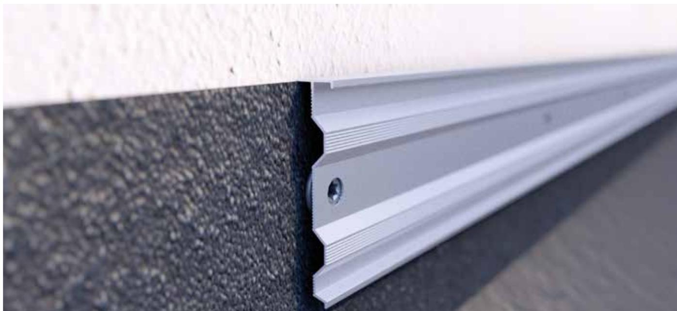
Le porte-solin permet de réunir proprement des surfaces de toit et de façade en fixant un carton goudronné sur le mur adossé pour créer un raccord parfait.
