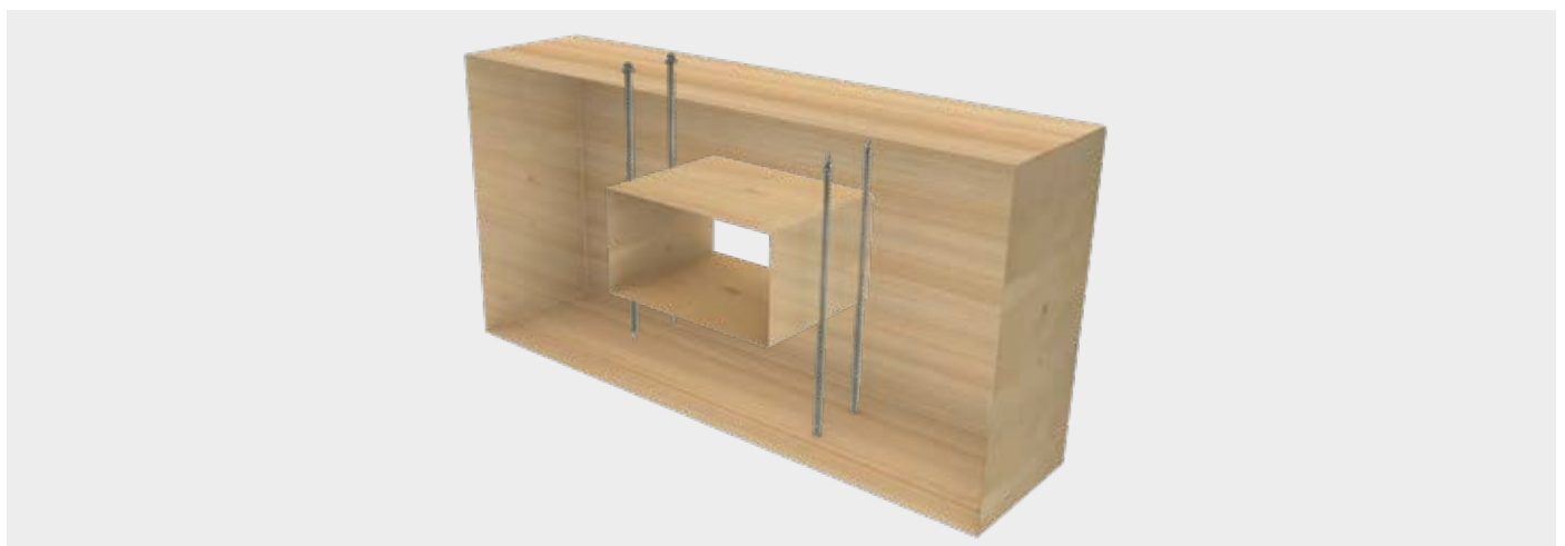
Refuerzo de aberturas de vigas
