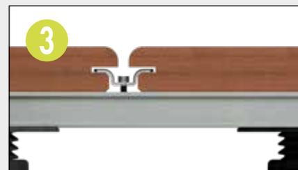
3 Inserte los demás Clip-V y atornillelos levemente. Los Clips-V colocados anterior pueden ahora fijarse firmemente. ¡Asegúrese de que el torque de atornillado esté configurado correctamente!
