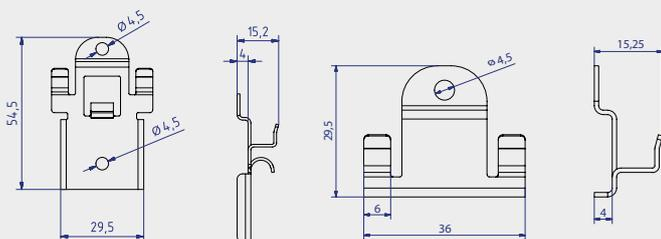
En el caso de instalación vertical, deben considerarse los siguientes puntos al emplear el Clip para fachadas Rhombus Starter. Para la formación de un borde de goteo del perfil Rhombus recomendamos ejecutar un goterón de 15°. El Clip para fachadas Rhombus Starter se ajusta perfectamente con un ranurado de 4 mm de ancho en el perfil de madera (ver detalle A).
