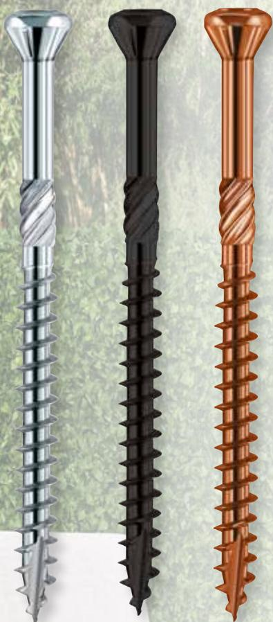
El tornillo Hapatec de acero inoxidable endurecido es un fijador de paneles especialmente diseñado para madera dura. El tornillo tiene una ranura rascadora en la punta, nervios de fresado por encima de la rosca y una cabeza decorativa. El Hapatec también está disponible en color antiguo y negro.
