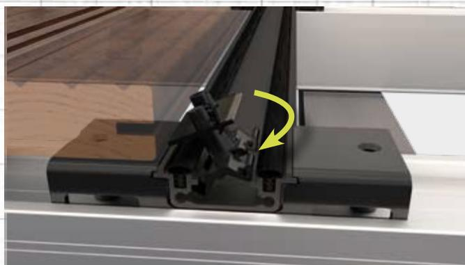
**5** Encaje el carril EVODry con los clips EVODry en la tabla y fíjela con un tornillo de perforación (largo 41).
