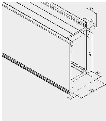
Cortes en el perfil de soporte para la conexión de perfil de soporte y perfil de cubierta en la zona de las esquinas.
