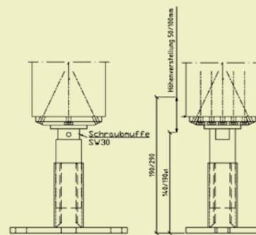
Introduzca todos los tornillos y coloque nuevamente el casquillo de protección y la placa base. Tras levantar el pilar con el portapilar colocándose lo atornilla en los cimientos de hormigón con dos o cuatro tornillos de anclaje en sus agujeros prefabricados. Una vez montado, la altura del portapilar se puede regular fácilmente mediante el manguito roscado con una llave plane de 30 mm.
