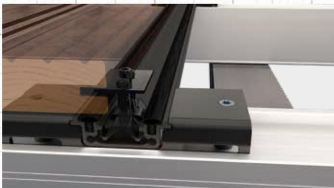
**6** Introduzca la segunda tabla en la placa de sujeción del clip EVODry y fíjela con el tornillo del clip EVODry.
