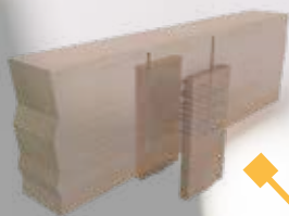
CONEXIÓN DE LENGÜETA LATERAL
