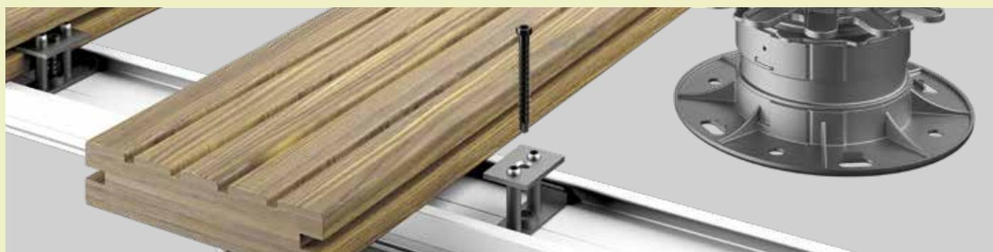
Fixation invisible d'une lame de bois au moyen du support de système Twin.
