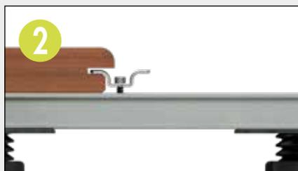
2 Insérez d'autres lames avec un espacement de 7 mm env. (mesuré au niveau du bord supérieur).
