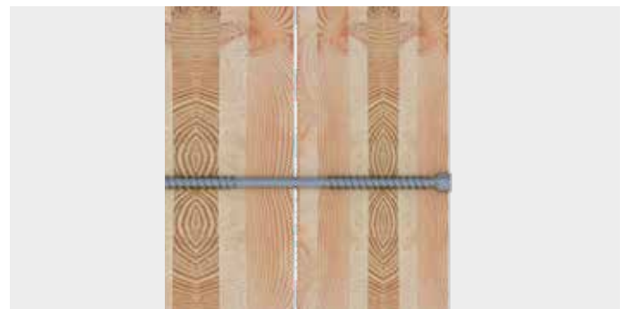
KonstruX DUO Vue en coupe entre deux composants
