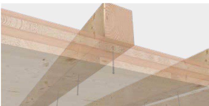
KonstruX DUO pour la fixation d'un revêtement
