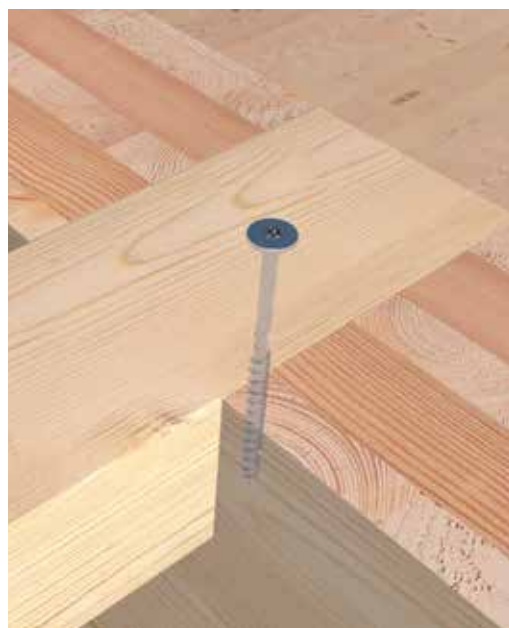
Une poutre est fixée à la paroi CLT entaillée à l'aide d'une vis à filetage partiel SawTec.
