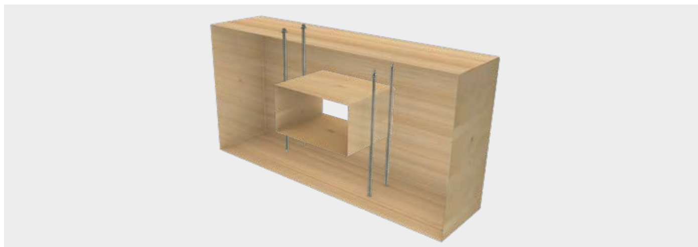
Renforcement des encoches de traverses
