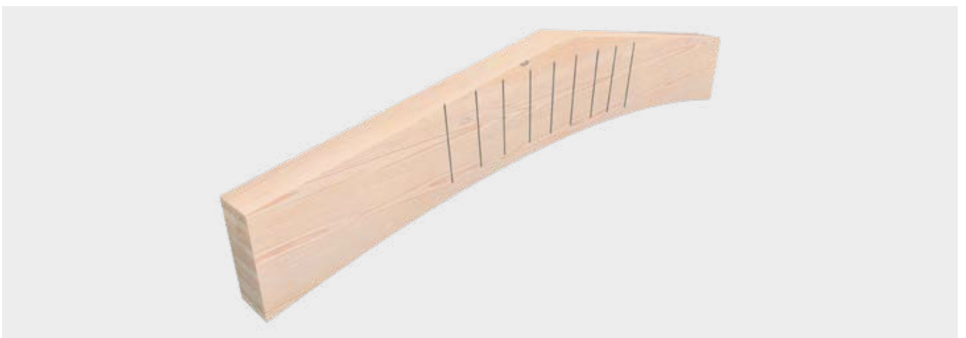
Renforcement de traverses courbées (sous forme de trapèze)
