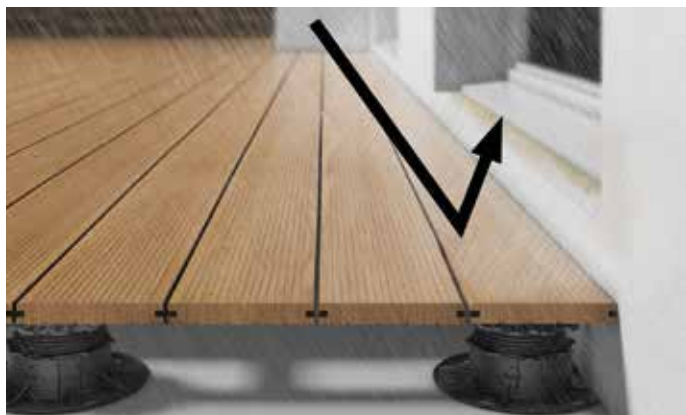
Bez DrainTec odbijana od podłoża woda deszczowa opryskuje element drzwi albo okładzinę elewacji.
