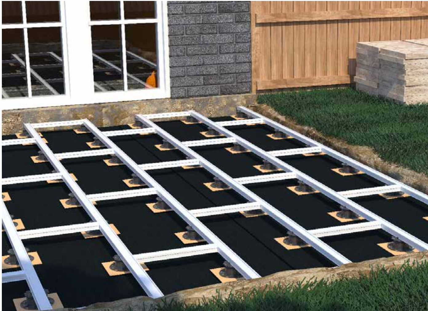
Konstrukcja nośna ze stopami przestawnymi PRO, aluminiowymi profilami systemowymi EVO i usztywnieniami poprzecznymi EVO
