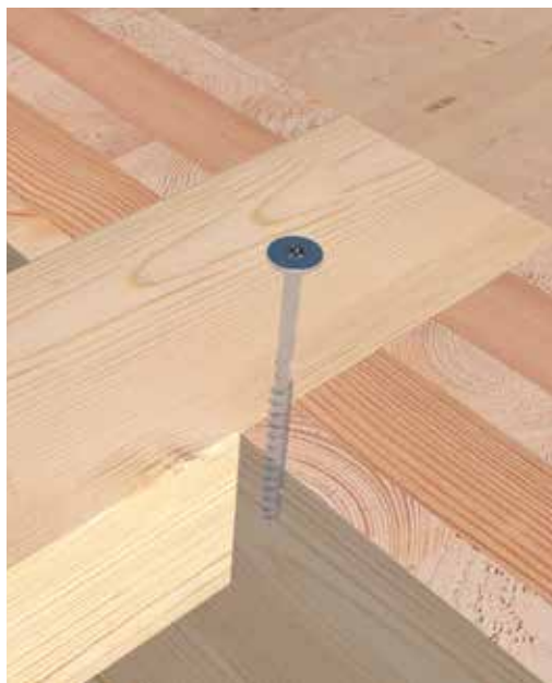
Una trave ribassata viene fissata alla parete CLT intagliata mediante le viti parzialmente filettate SawTec.
