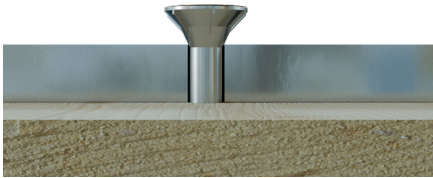
Cabeza avellanada en un orificio no avellanado a 90°
