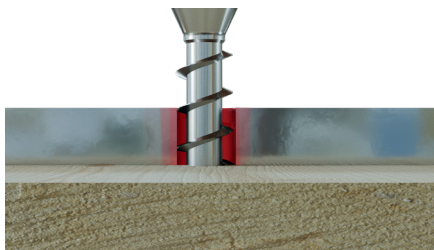
Gewindeschaden durch Reibung an der Lochleibung
