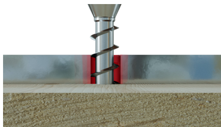
Détérioration du filetage due au frottement contre la paroi du trou
