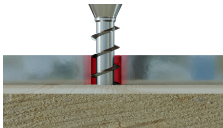
Danno alla filettatura causato dall'attrito contro il bordo del foro
