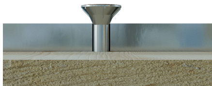
Tête fraisée dans un trou non pré-fraisé à 90°
