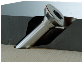
Trou à 45° avec tête fraisée dans un trou pré-fraisé
