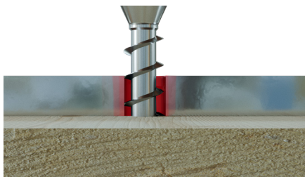
Uszkodzenie gwintu spowodowane tarciem o ściankę otworu
