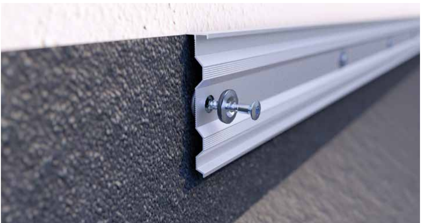
Befestigung einer Wandanschlussschiene mittels Spenglerschraube an einer Hauswand.
