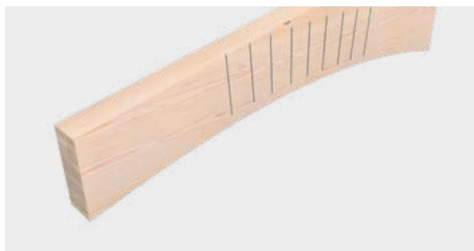
Verstärkung von trapezförmig gebogenen Balken
