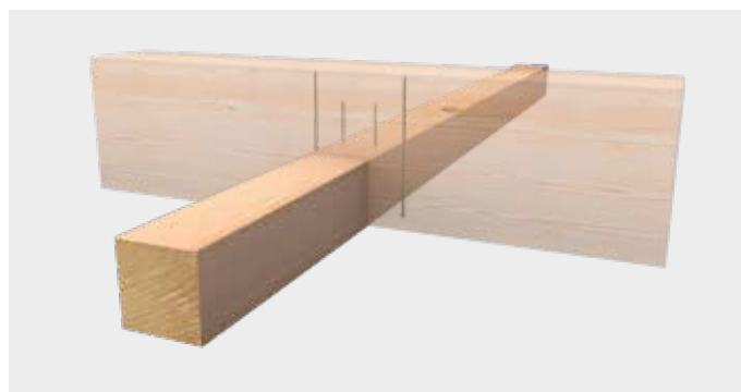
Verstärkung der Haupt-Nebenträgerstützen
