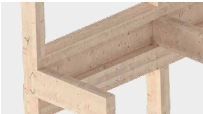
Befestigung von Stützen bei Holzrahmenkonstruktionen sowie Haupt-/Nebenträger-Anschlüssen
