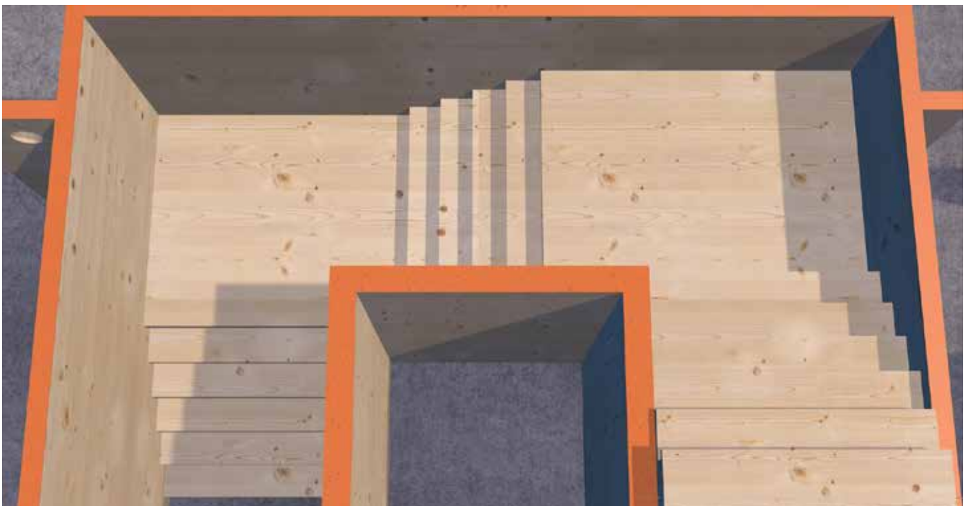
Stufen oben auf der Stufenauflage anbringen.
