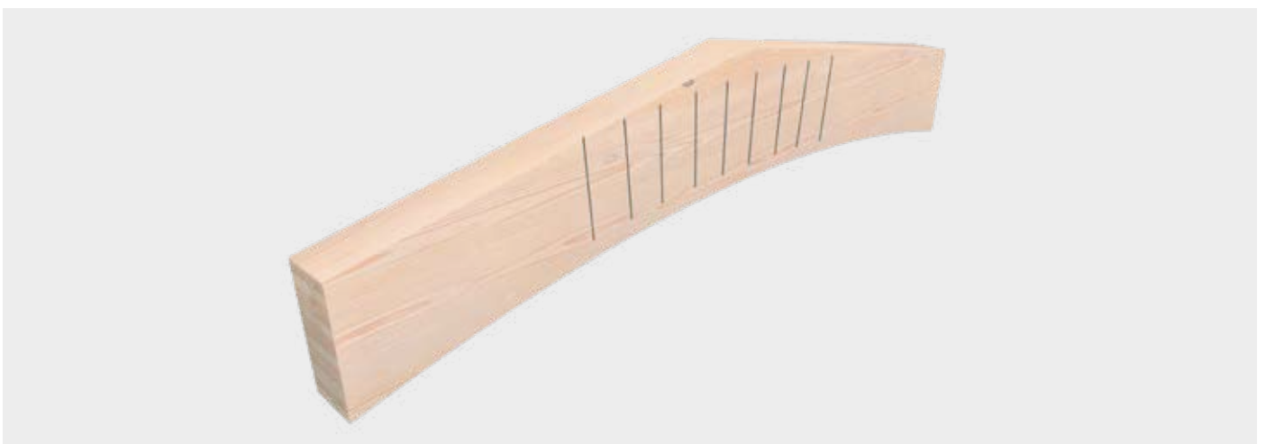
Verstärkung von trapezförmig gebogenen Balken
