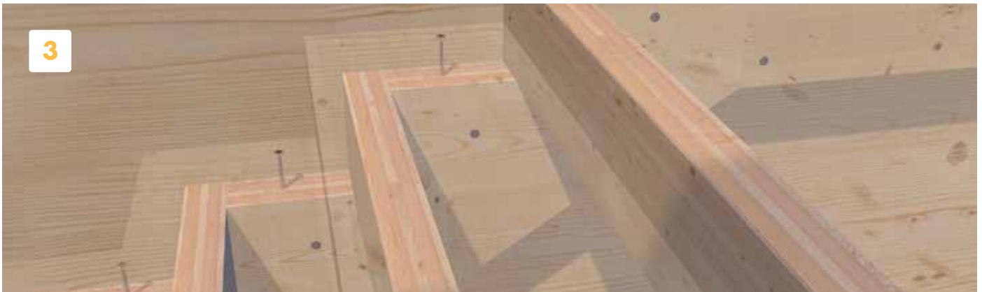
Stufen oben auf der Stufenauflage anbringen.
