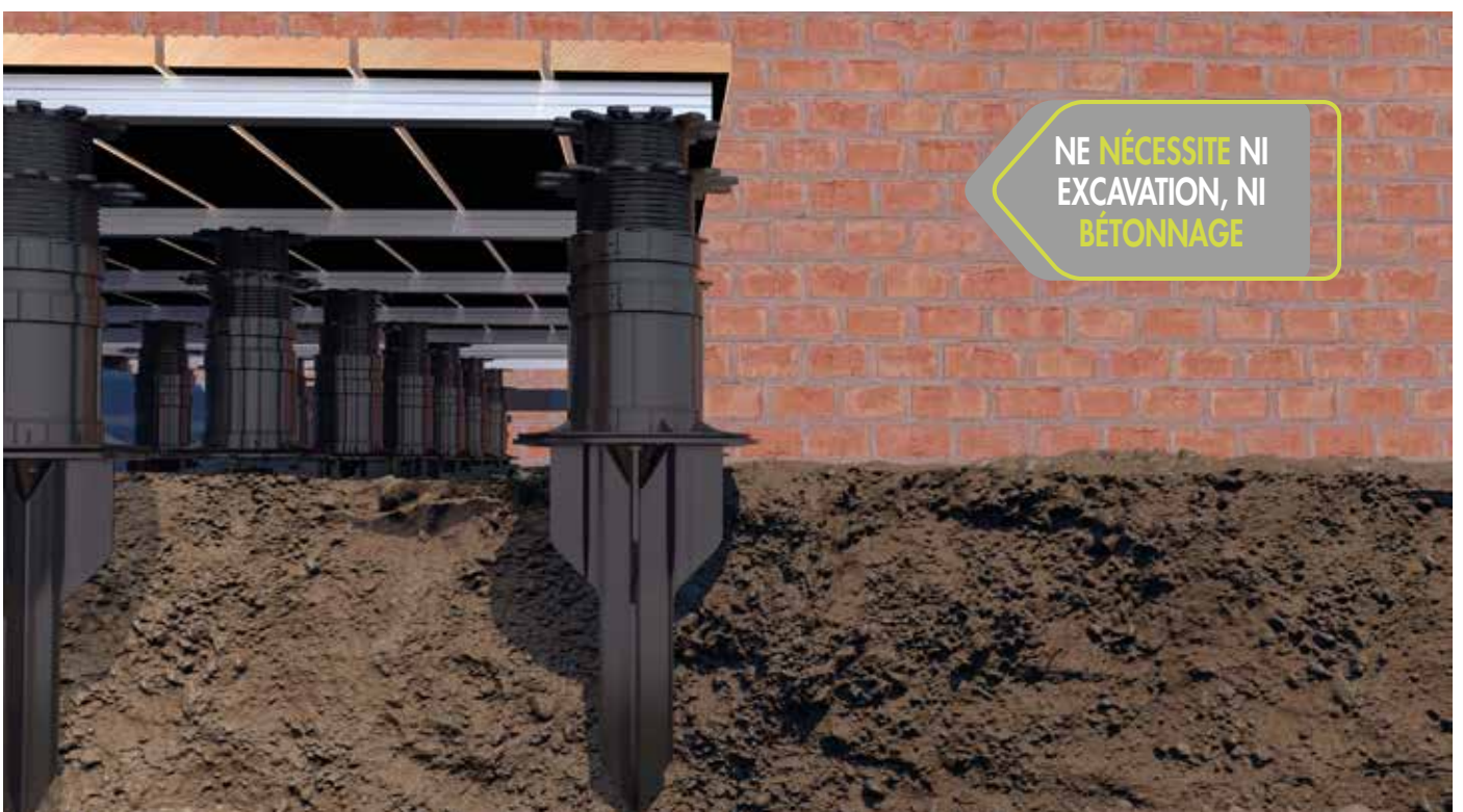
Tirant d'ancrage FLEXI en tant que base stable pour l'ossature porteuse de terrasse.
