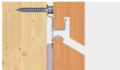
Przylączy ścienne z rombowym zaciskiem do elewacji
