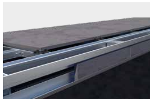
Przykład zastosowania profile zakończeniowe do aluminiowych konstrukcji spodnich
