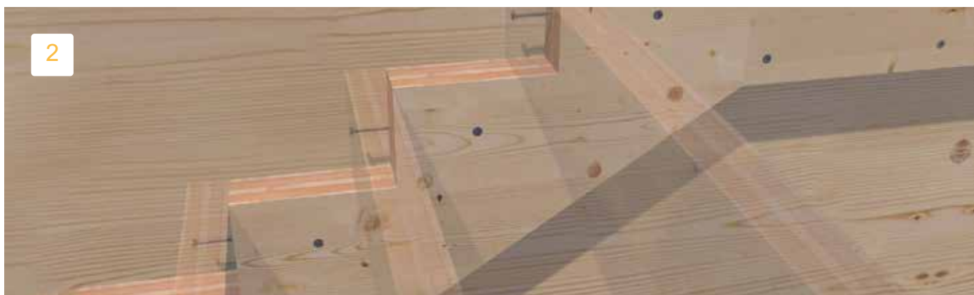
Zamontować zakończenie stopni od czola przy wsporniku stopni.
