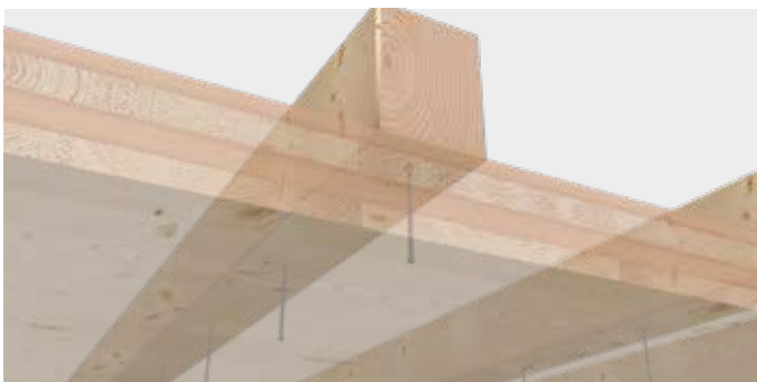
KonstruX DUO do mocowania nadciągu
