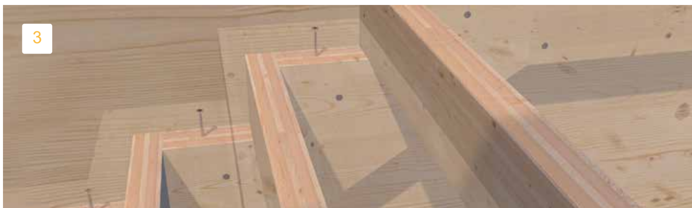
Zamontować stopnie na górze na wsporniku stopni.
