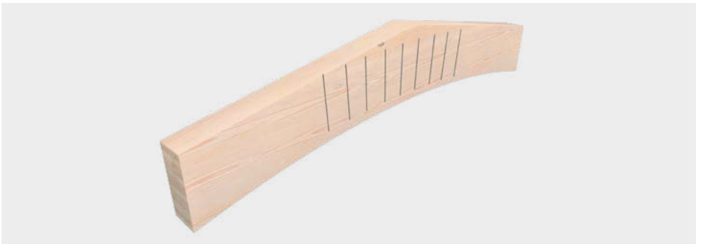
Wzmocnienie belek giętych na kształt trapezu
