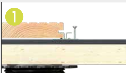
Befestigung der Schrauben in die verfügbaren Bohrungen.
