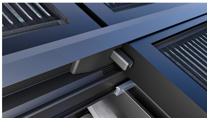
SCHRITT 23: Zwischen jedem Solarmodul wird in der oberen Einlegeschiene ein Abstandshalter LayTec eingesetzt. Dieser verhindert, dass das Solarmodul wieder nach oben heraus kann und schafft automatisch einen Abstand von 10 mm zwischen den Solarmodulen.
