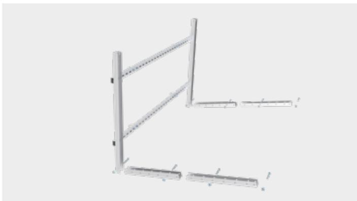
**SCHRITT 2:** Profile wie dargestellt montieren.
