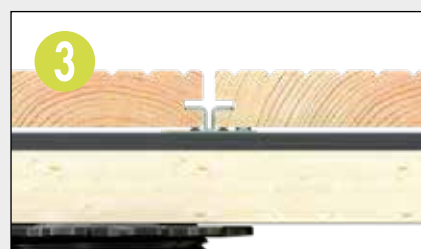
Fijación de los tableros con un sargento hasta que la junta de la madera sea de 5 mm.
