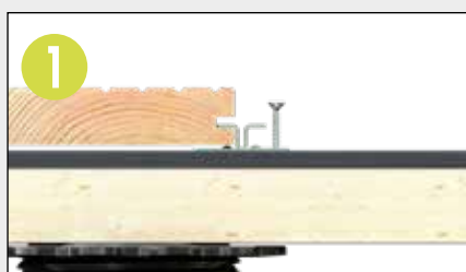
Fijación de los tornillos en los orificios disponibles.
