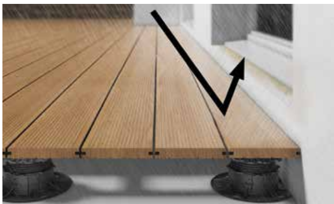
Sin DrainTec, las salpicaduras de lluvia llegan a las puertas y revestimiento de fachada.
