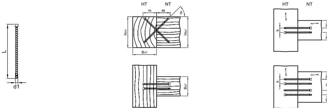
$a_2 = \text{min. } 50 \text{ mm}, a_{2,c} = \text{min. } 30 \text{ mm}, k = \text{min. } 15 \text{ mm}$
