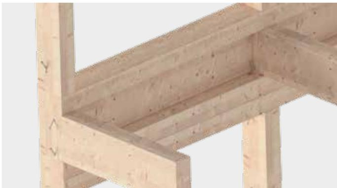
Befestigung von Stützen bei Holzrahmenkonstruktionen sowie Haupt-/Nebenträger-Anschlüssen
