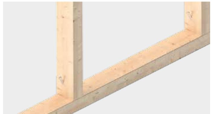
Befestigung von Stützen bei Holzrahmenkonstruktionen im Fußschwellenbereich
