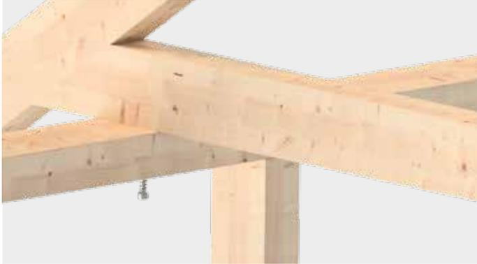
Befestigung von Querträgern bei leichten Holzrahmenkonstruktionen
