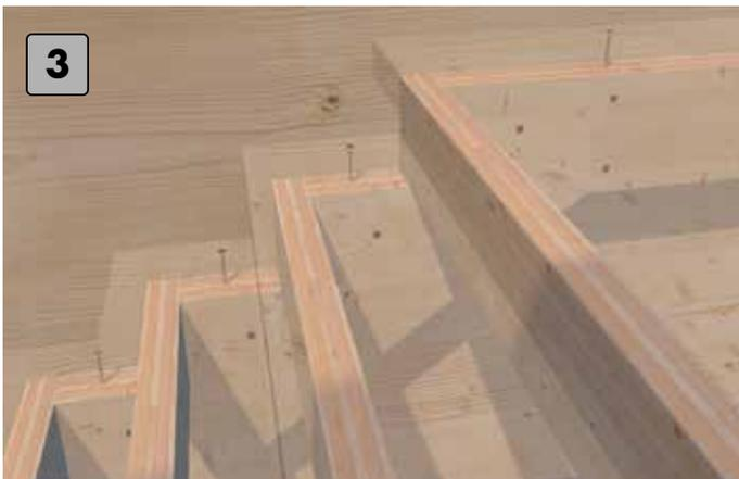
3 Stufen oben auf der Stufenauflage anbringen.
