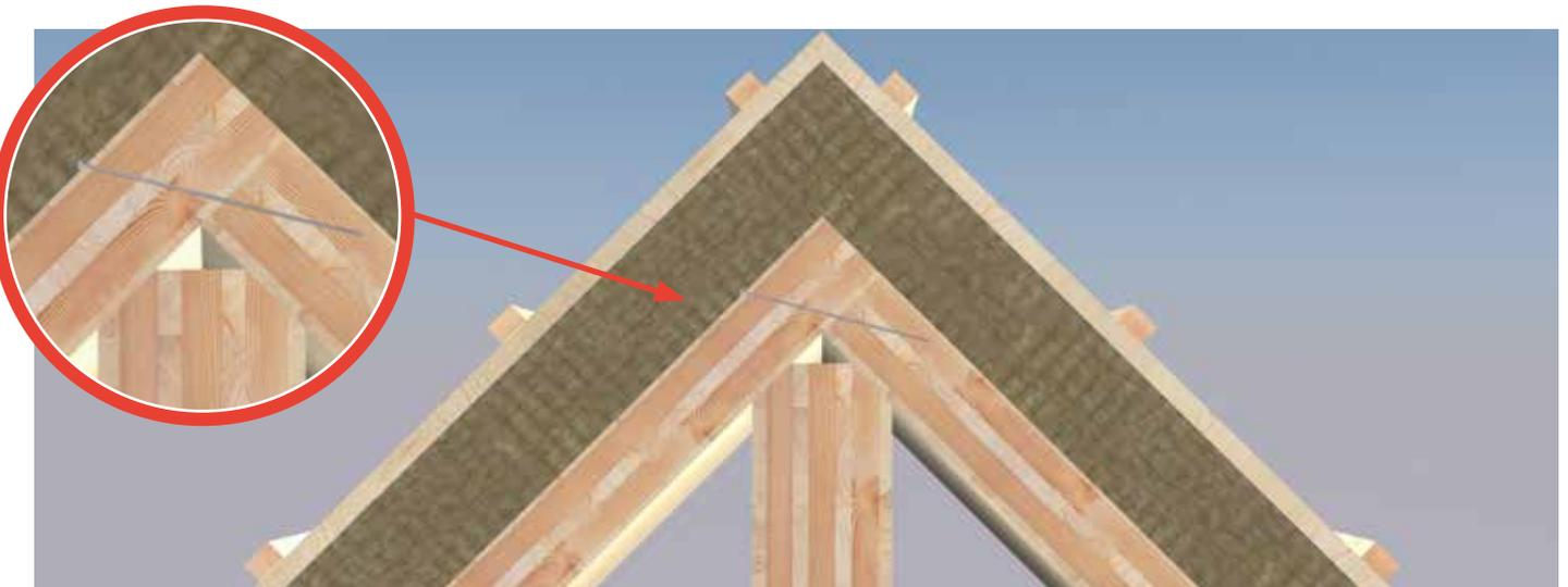
*Dachplatten auf Stoß – Schrägverschraubung*
