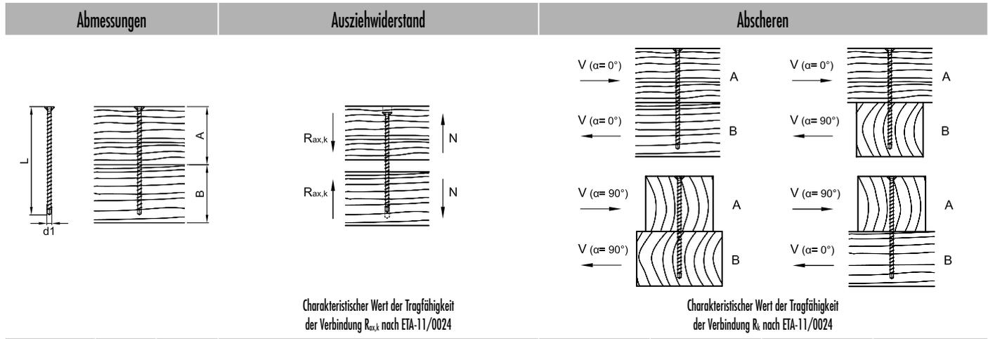
Charakteristischer Wert der Tragfähigkeit der Verbindung  $R_{ax,k}$  nach ETA-11/0024
