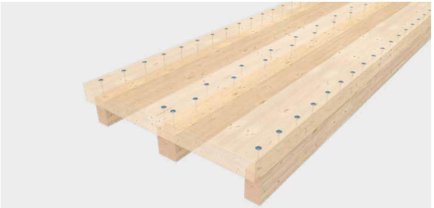
Pressdruckverteilung bei der Schraubenpressklebung von Holzrippenelementen
