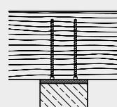
Querzugverstärkung an Ausklinkung
