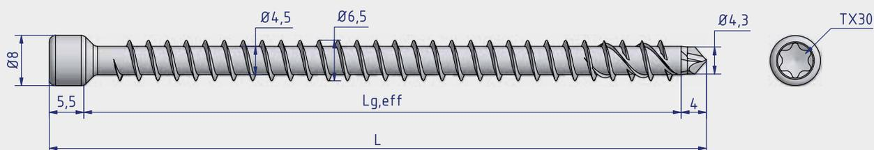
KonstruX ST ZK  $\varnothing 6,5 \times L$  -TX30
