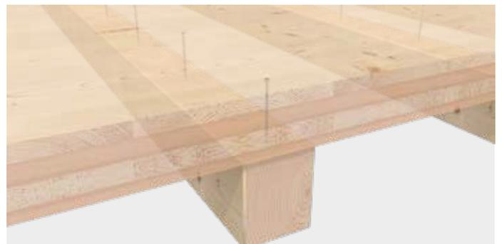
KonstruX DUO zur Befestigung eines Unterzugs
