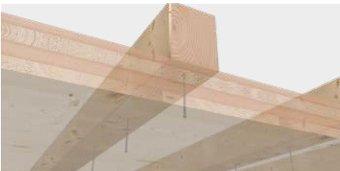
KonstruX DUO zur Befestigung eines Überzugs
