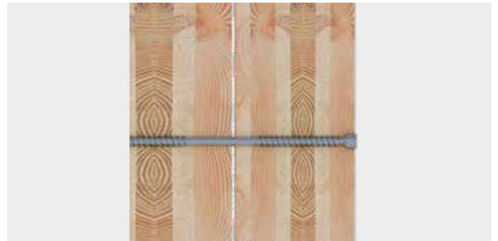
KonstruX DUO Schnittansicht zwischen zwei Bauteilen
