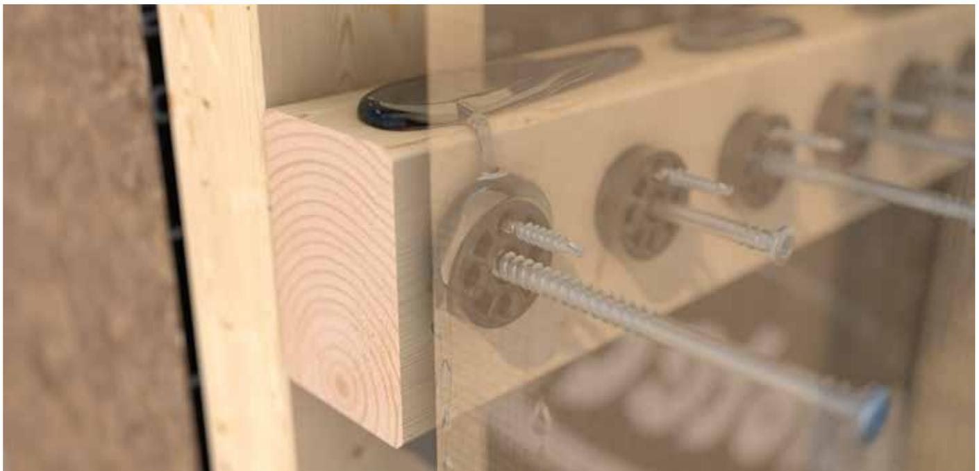
Beispiel: Zusammenbau 3D-Fassade mit Abstandhalter. Bietet optimalen Holzschutz durch Wasserablauf.
