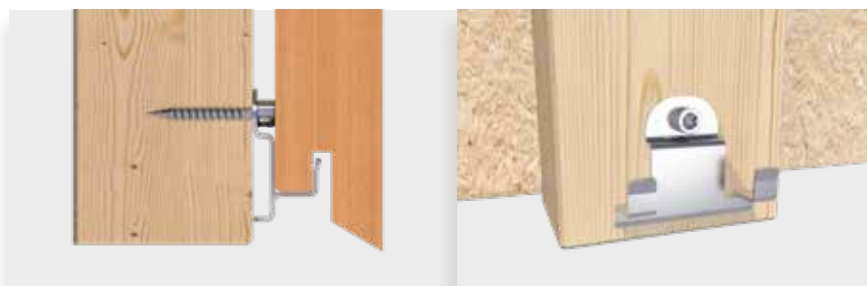
Klips fasadowy Rhombus Starter, zastosowanie na pionowej podkonstrukcji drewnianej
