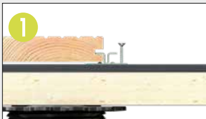
Befestigung der Schrauben in die verfügbaren Bohrungen.
