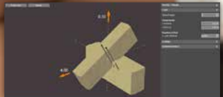
Moduł do połączenia krokwi z płytami przy użyciu rub Panelwistec i KonstruX.
