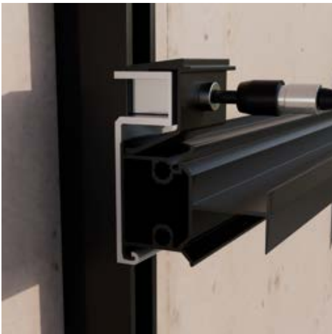
SCHRITT 7: Einlegeprofil ausrichten (vertikaler Abstand zwischen den Einlegeprofilen: Modulhöhe +8mm) und anschließend alles mithilfe der Schraube des Profilverbinders arretieren.
