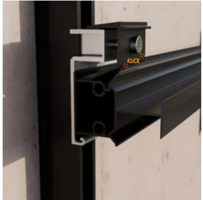
SCHRITT 6: Einlegeprofil nach unten drehen und in Profilverbinder einklicken.
