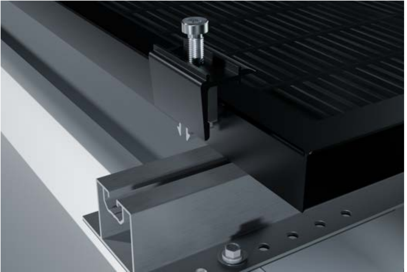
SCHRITT 2: Im zweiten Schritt werden die Solarpaneele auf das Montageprofil Trapezblech EASY gesetzt.
