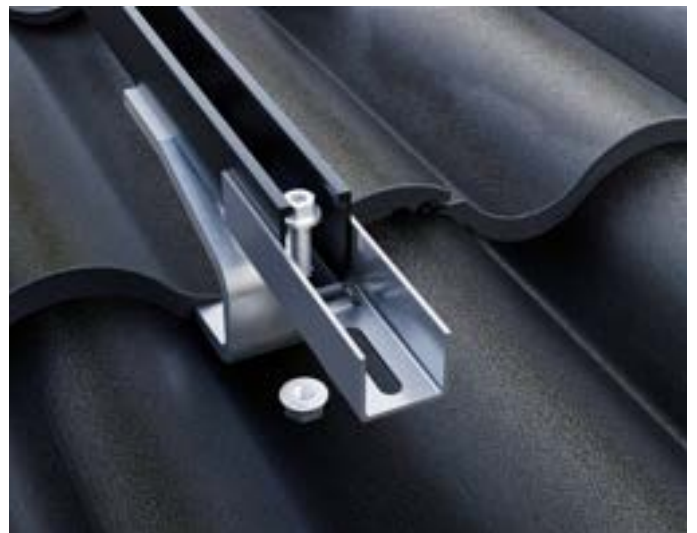
SCHRITT 6 (OPTIONAL): Wenn nötig können die Basisprofile mithilfe des Längsverbinder Basisprofil und der Fixierschraube LayTec, sowie M8 Muttern verbunden werden.
