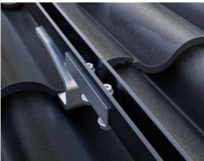
SCHRITT 7 (OPTIONAL): Nachdem ein weiteres Basisprofil aufgesetzt wurde, wird dieses wieder mit einer Fixierschraube LayTec und einer M8 Mutter verschraubt.
