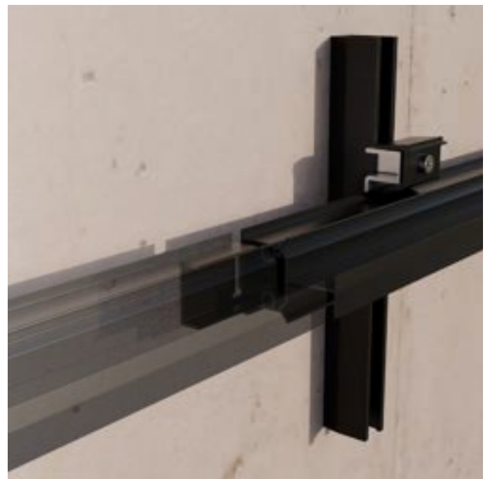
OPTIONALER SCHRITT 6.2: Um das Einlegeprofil zu verlängern können Sie einfach den Längsverbinder Einlegeprofil in das Einlegeprofil einschieben und das zweite Profil daraufschieben. Bitte beachten: diese Verlängerung dient zur Führung und ersetzt keinen Befestigungspunkt.
