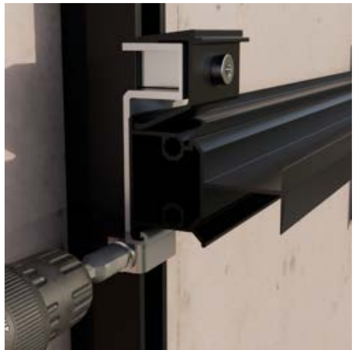
SCHRITT 8: Fassadensicherung unterhalb des Profilverbinders anlegen und mit Bigthy-Schraube an das Basisprofil befestigen.
