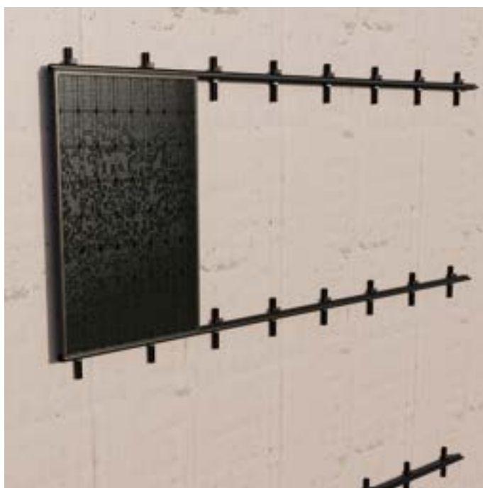
SCHRITT 10: Eingelegtes Solarmodul
