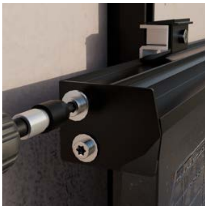
SCHRITT 13: Zum Schluss wird die Enkappe auf das Ende der Einlegeprofile gesetzt und mit den Fixierschrauben verschraubt.
