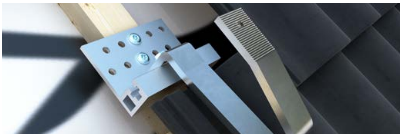
Dachhaken LayTec an der Konterlatte montiert, durch die ausgeklinkte Dachpfanne geführt.
