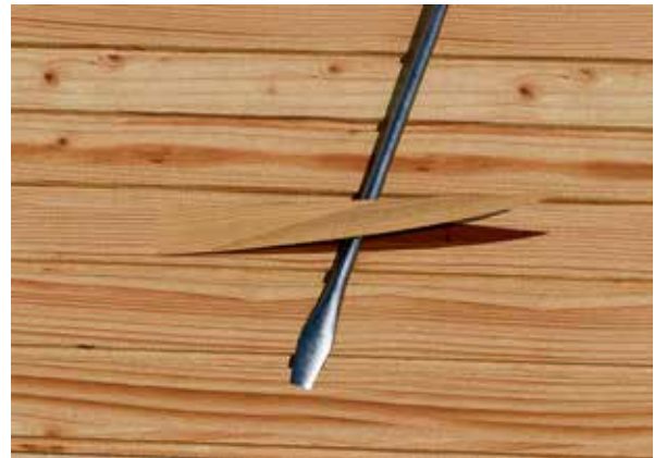
Ringschäle bei Nadelhölzern
